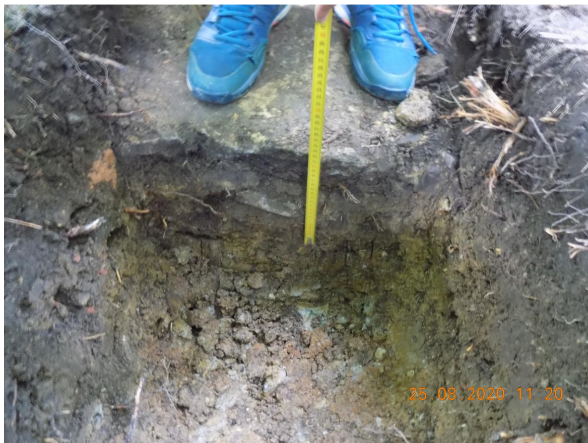
Foto č.2 Detailný pohľad na vrstvy základových pomerov
